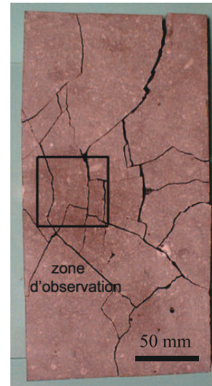
FIG. 4.3: Carreau reconstitué après l'essai 1 (tableau 4.1).
