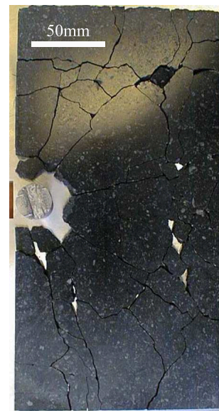
FIG. 4.5: Carreau reconstitué après l'essai 2 (tableau 4.1).
