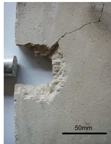
FIG. 4.7: Carreau reconstitué après l'essai 3 (tableau 4.1).
