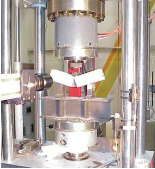
FIG. 3.19: Montage de flexion trois points.
