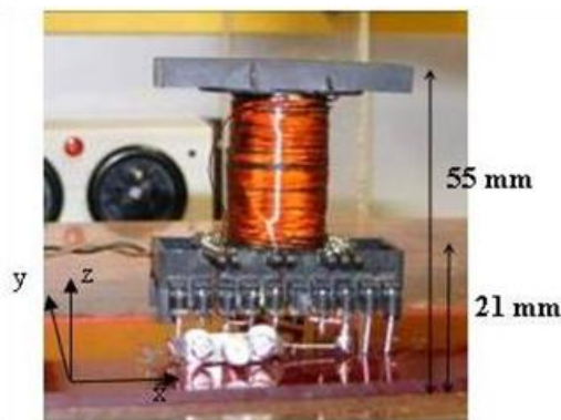
Figure 28 : Dispositif sous test (bobinage de 50 spires)
