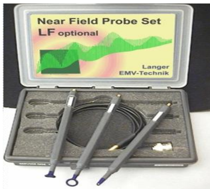
Figure 172 : Kit des sondes de mesure de champ magnétique proche
