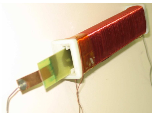
Figure 2.5 : GMI sandwich à l'intérieur du bobinage de polarisation.
