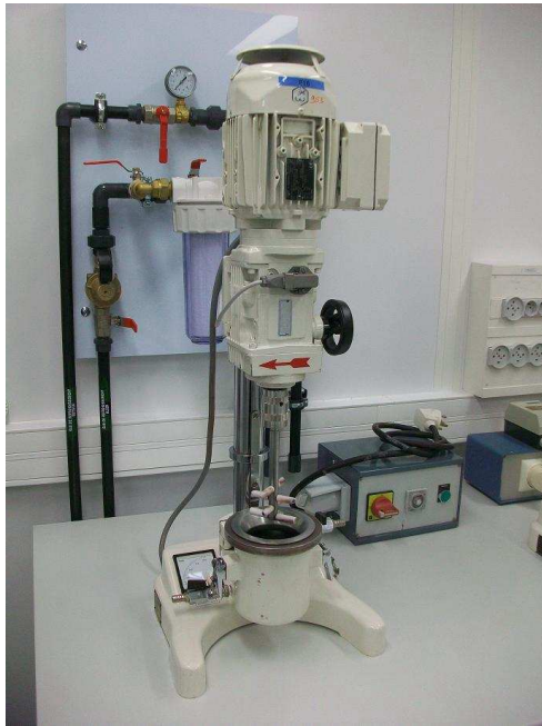
Figure 146 : Photographie du broyeur par attrition (gauche).
