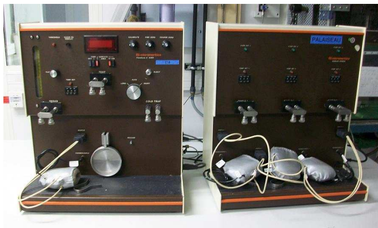
Figure 156 : Photographie de l'appareil Flowsorb II 2300 utilisé pour les mesures de surfaces spécifiques.
