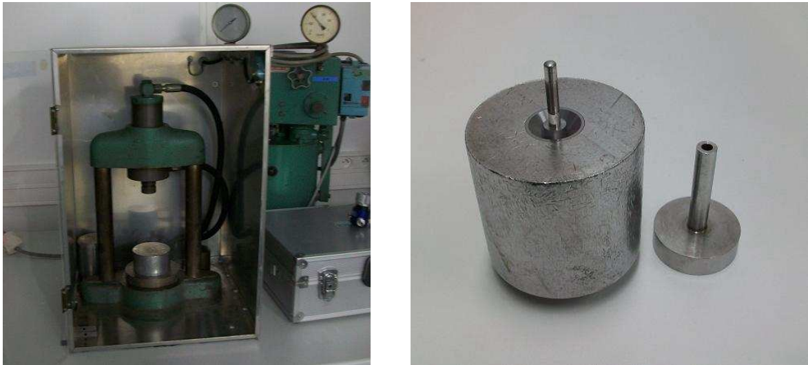
Figure 147 : Photographie de la presse axiale (gauche).
