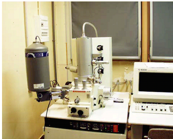
Figure 160 : Microscope à balayage Hitachi S4000 utilisé pour l'imagerie.
