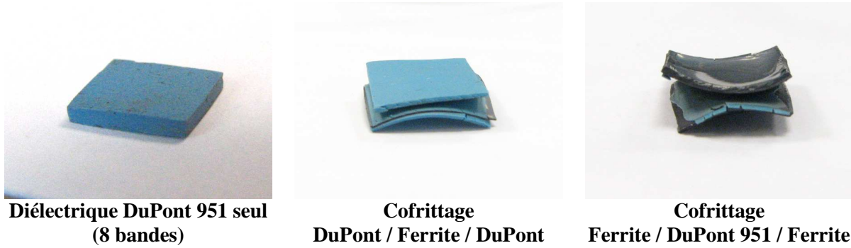
Figure 118 : Exemples de cofrittages Ferrite / DuPont 951 à 900°C pendant 2 heures sous air. Conditions standards de laminage.
