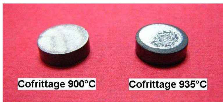
Figure 103 : Photographies des cofrittages ferrite - argent réalisés à 900 et 935°C pendant 2 heures sous air.
