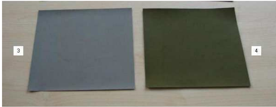
Figure 113 : Exemples de bandes coulées réalisées au laboratoire.
