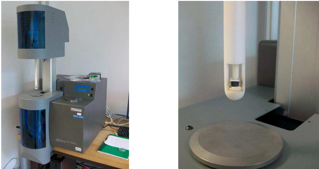
Figure 157 : Photographies de la SETSYS Evolution utilisée pour les analyses thermomécaniques.
