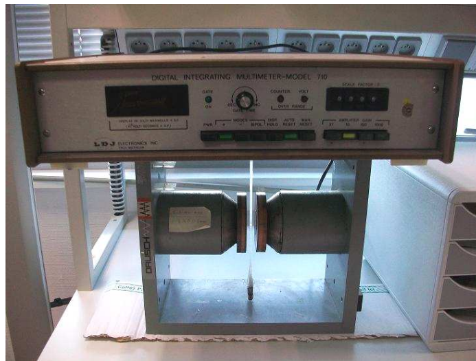
Figure 162 : Photographie de la balance magnétique permettant de déterminer l'aimantation à saturation.
