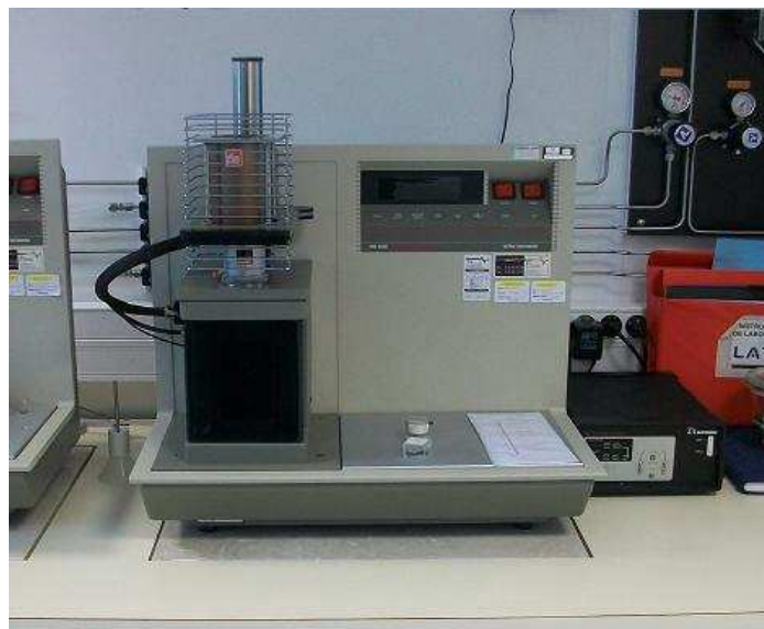
Figure 158 : Photographie de l'appareil TMA 2540 utilisé pour la mesure de CTE.
