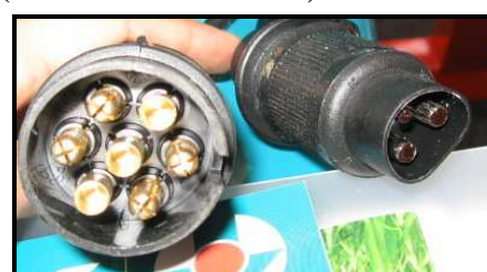
Figure 1.9: Prise électronique (à droite) et électrique (à gauche)
