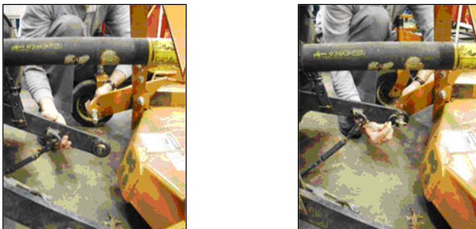
Figure 5.8 : Accrochage des bras inférieurs (HOSTA, 2004)
