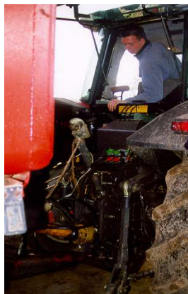
Figure 5.7 : Attelage trois points et outil - phase d'approche (MAP, 2006)
