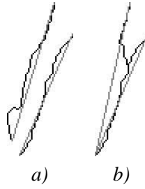
FIG. 2.87 – Deux configurations possibles pour deux paires de noeuds : influence de la position des noeuds sur les chemins calculés (en noir) qui peuvent se superposer si les noeuds sont trop proches (à droite)
