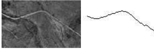
FIG. 2.86 – A droite, la route joignant deux extrémités obtenue par ELIESER ; A gauche, l'image SPOT correspondante.
