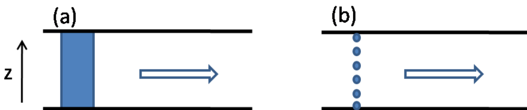
Figure I.16- Illustration conceptuelle du passage d'une source étendue (a) de colorant injectée dans une fracture idéale, à un ensemble de sources ponctuelles (b) à partir desquelles sont calculés les moments locaux. La flèche symbolise le futur écoulement dans la fracture.
