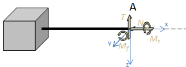
FIG. I3 - 8 – Définition des efforts internes dans les poutres étudiées, et convention de signe (tous les efforts et moments représentés ici sont orientés positivement). T et N sont respectivement l'effort tranchant et l'effort normal. M_f et M_t sont le moment de flexion et le moment de torsion subis par la poutre.
