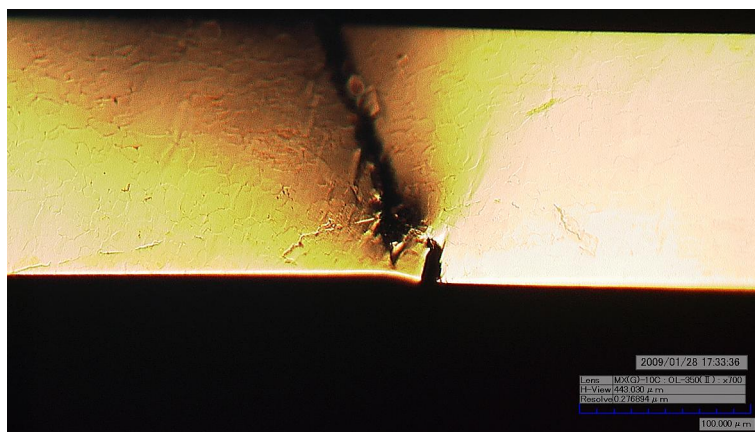
FIG. III4 - 12 – Rupture d'une éprouvette d'or électrodéposé (Au IV 300-1). L'essai de traction a été stoppé avant rupture totale de l'échantillon. On observe une concentration importante de bandes à 60° proche de la rupture, avec une ouverture de celles qui sont traversées par la fissure. La fissure est également inclinée à 60°.
