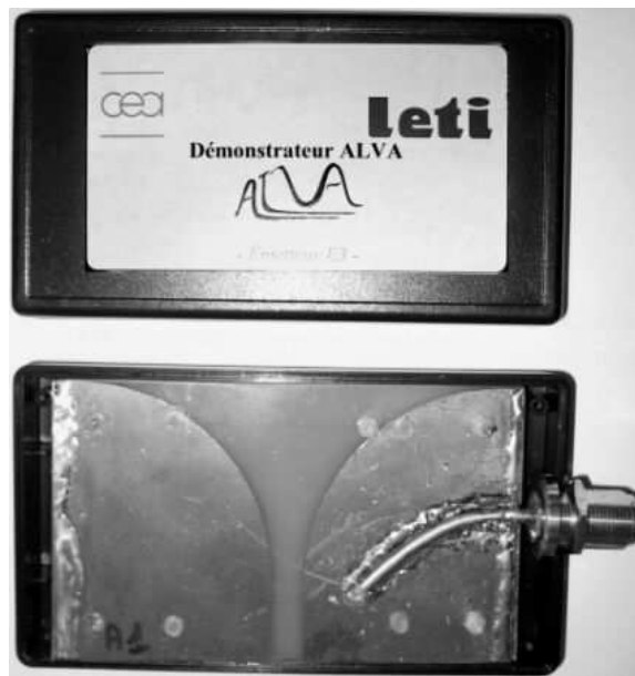
Figure 6 - 5 : Antenne de réception mise en boîtier ABS (conditionnement identique à l'émetteur)
