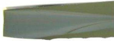
Figure 27 : Substrat de silicium vu du dessus. Dépôt caractéristique sur les substrats dont la forme est liée à la trace du flux de réactifs. À l'échelle 1, longueur d'environ 5 cm.
