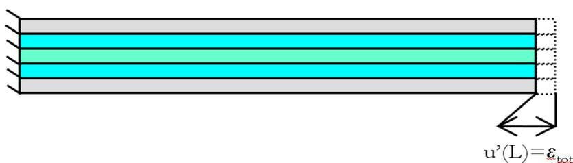
Figure 66 : conditions limites d'un stratifié encastree-libre
