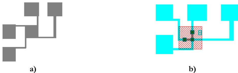
Figure 94 : test paramétrique de type a) Van der Paw, et b) Kelvin
