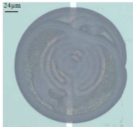
Figure.20 : Exemple d'un dépôt de mauvaise qualité avec une température de 110°C
