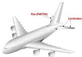
Figure IV.5 - Gouvernes de contrôle en tangage
