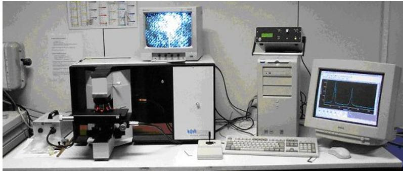
**Fig. 4.4 :** Image du dispositif LabRam Jobin Yvon de mesure par spectroscopie micro-Raman.
