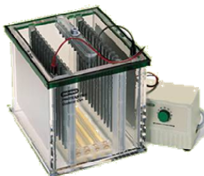
Figure 4: Photo du matériel utilisé au laboratoire de protéomique de bioMérieux pour la deuxième dimension de l'électrophorèse (Bio-Rad PROTEAN Plus™ Dodeca™)
