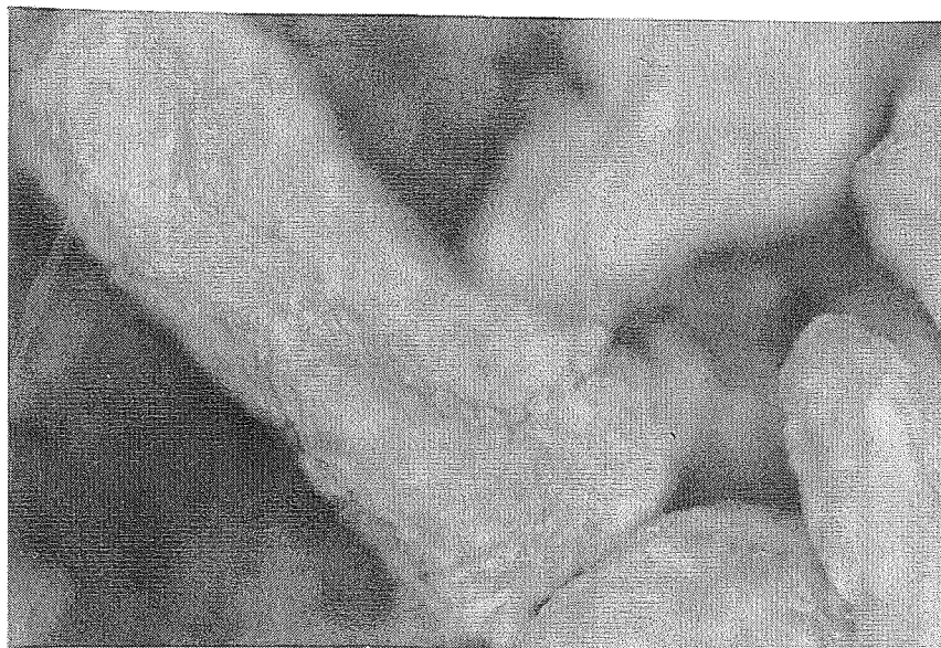
Photo II.2 : grains de magnésium recouverts d'une couche d'oxyde (essai réalisé à 505°C sous une pression partielle d'oxygène de 250 hPa, degré d'avancement : 0,15).
