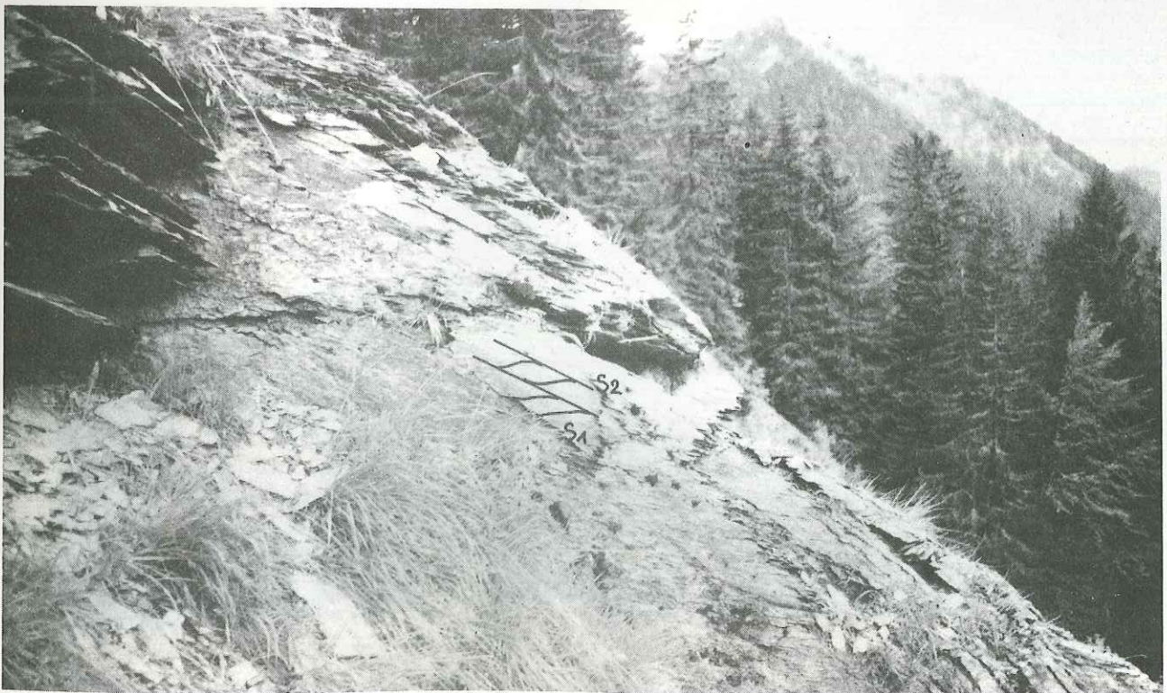
Photo 9 - Les différents plans de schistosité dans les schistes liasiques du Signal du Sac; coupe suivant un plan de fracture .
