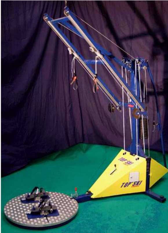
Figure 24 : ergomètre de musculation pour l'entraînement au ski de fond.
