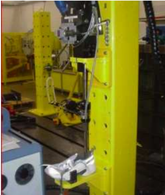
Figure 28 : la mise à l'épreuve d'un prototype : test de contrainte mécanique sur une chaussure de sport.
