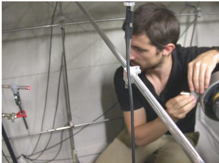
FIG. 5.6 – **Orientation du dipôle.** Le dipôle est monté sur une tête articulée fixée à un pied dont la hauteur est réglable. L'opérateur pointe le laser épousant le corps de la source vers le microphone de contrôle  $M$  de manière à vérifier que le micro soit inclus dans le plan de zéro de pression.
