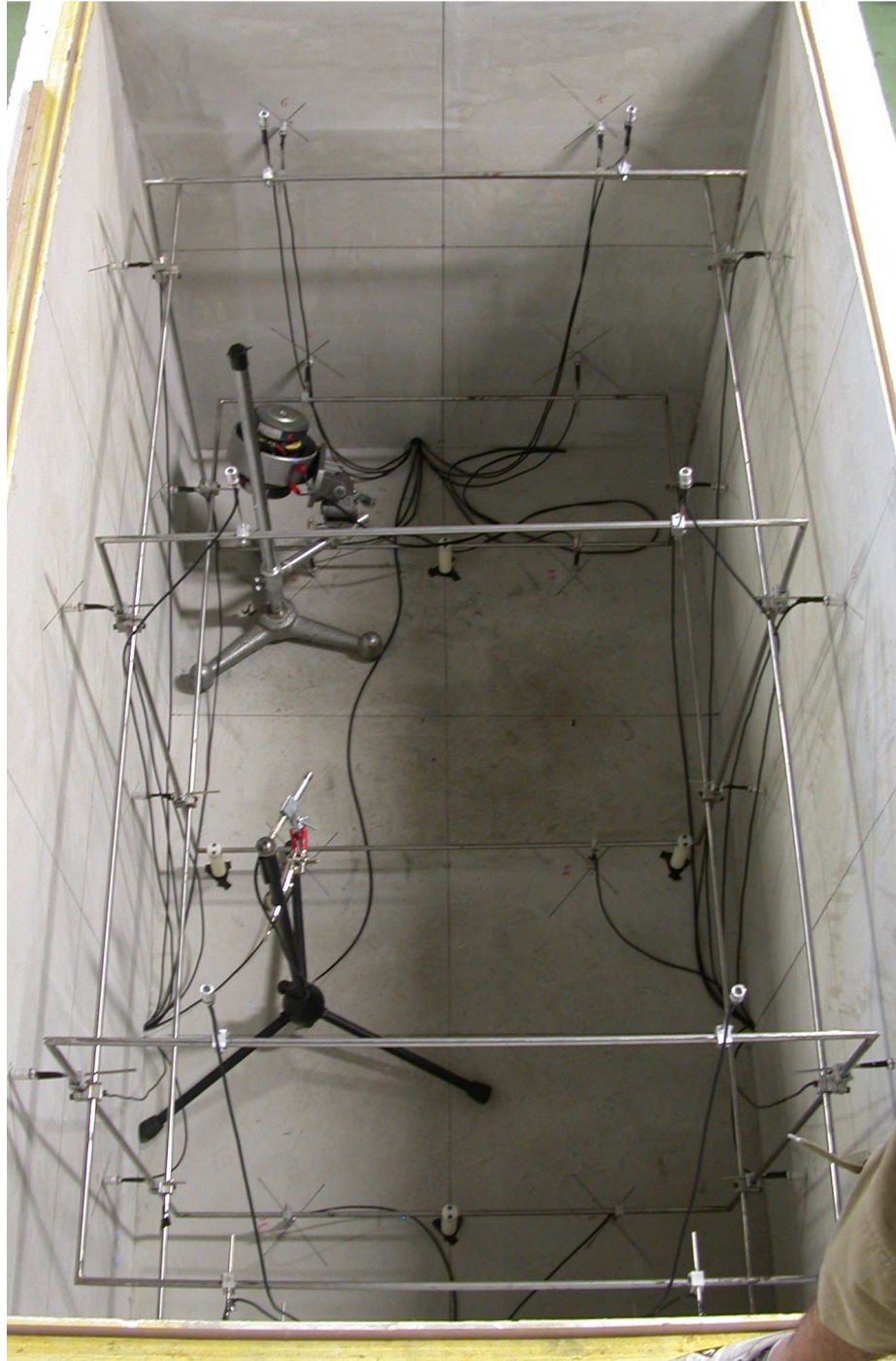
FIG. 5.5 – Dispositif expérimental dans la cavité réfléchissante. Un cadre en acier supporte les 32 micros d'estimation. Ils sont placés au centre des éléments représentés sur les parois de la maquette. Dans le coin de la maquette, la source est placée sur un pied réglable en hauteur et sur une tête articulée. Supporté par un pied de couleur noir, on aperçoit le microphone de contrôle M , au niveau duquel on cherche à estimer les échos.
