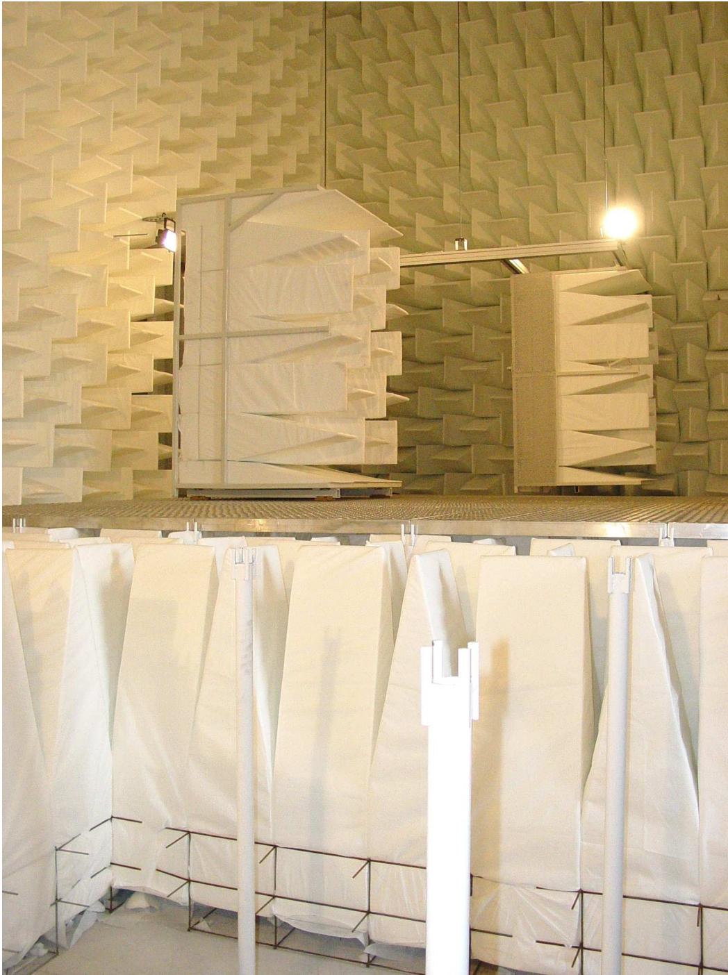
FIG. 1.1 – Photo de l'intérieur de la chambre anéchoïque du LMA. Les 3720 dièdres couvrant l'intégralité des parois sont en mélamine. Ils mesurent 1.2 m de long.
