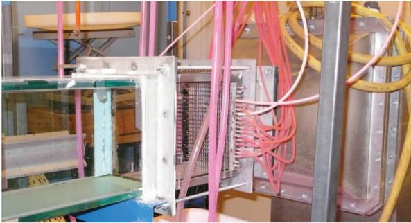
FIGURE 1.1 – Turbulence de grille
