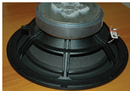
FIGURE 1.6 – Haut-parleur CA21 REX, membrane en cellulose
