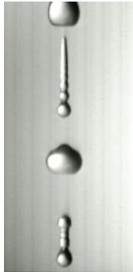
FIGURE 2.1 – Déstabilisation d'un jet sortant d'un orifice
