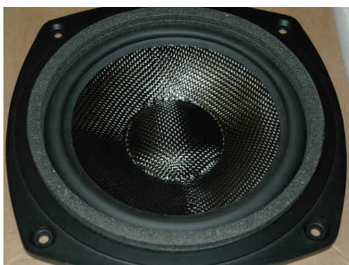
FIGURE 1.7 – Haut-parleur 20MC8A, membrane en carbone
