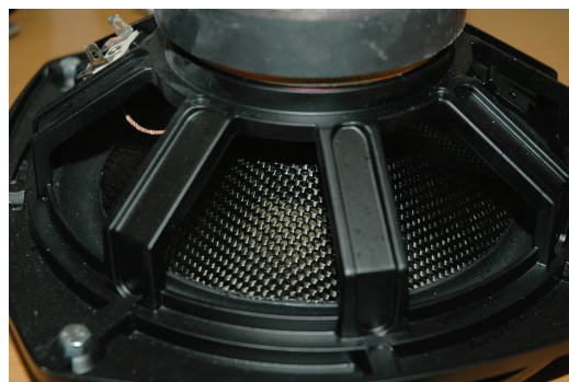
FIGURE 1.7 – Haut-parleur 20MC8A, membrane en carbone
