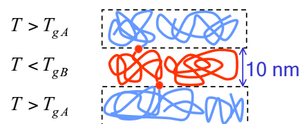
Figure 4.19: Schématisation d'un copolymère bloc nanostructuré composé d'une superposition de lamelles vitreuses et caoutchoutiques. Certaines molécules, appelées molécules liantes, assurent une cohésion forte entre les lamelles de polymères.
