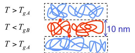
Figure 4.19: Schématisation d'un copolymère bloc nanostructuré composé d'une superposition de lamelles vitreuses et caoutchoutiques. Certaines molécules, appelées molécules liantes, assurent une cohésion forte entre les lamelles de polymères.
