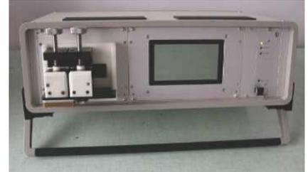
Figure 2.4: Photographie d'un dispositif de mesure de PTE conçu, réalisé à l'INSA et commercialisé par Techlab<sup>5</sup>.
