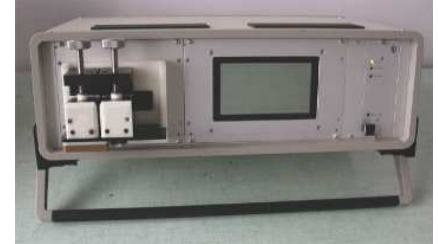
Figure 2.4: Photographie d'un dispositif de mesure de PTE conçu, réalisé à l'INSA et commercialisé par Techlab 5 .
