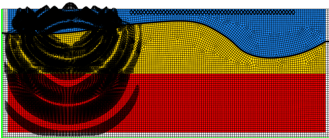
Fig. 4.18 – Propagation d’ondes sismiques dans un modèle à trois couches avec une couche fluide surmontant deux couches solides. L’instantané est pris au temps t = 0,560 s. Les 51 récepteurs sont représentés par des losanges. La couche bleue représente le fluide tandis que les couches jaune et rouges sont des couches solides et les zones blanches représentent les couches absorbantes.
