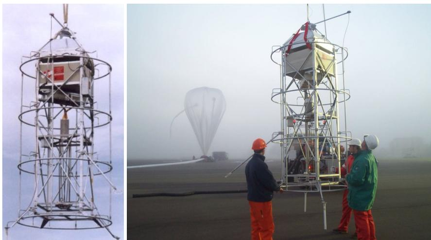
Figure 25 : A gauche, gros plan sur la nacelle SDLA. A droite, préparation du décollage : la nacelle est soulevée par le ballon auxiliaire alors que le ballon principal est encore au sol (au fond). Source : CNRS.
