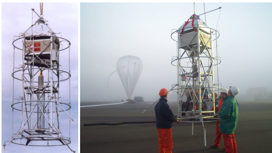
Figure 25 : A gauche, gros plan sur la nacelle SDLA. A droite, préparation du décollage : la nacelle est soulevée par le ballon auxiliaire alors que le ballon principal est encore au sol (au fond). Source : CNRS.
