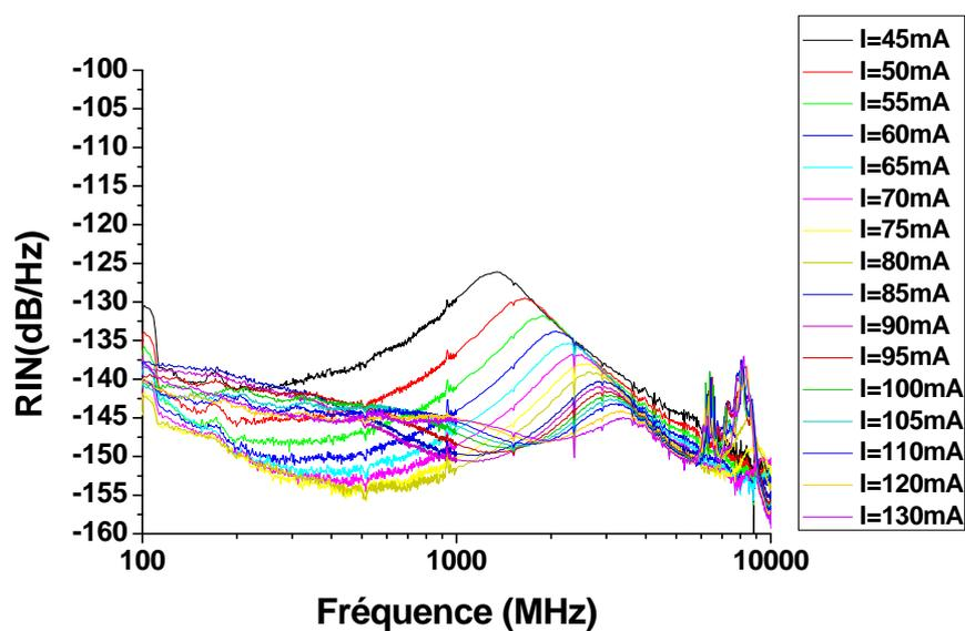
FIGURE 6.13 – Mesure du RIN dans un laser à îlots quantiques
