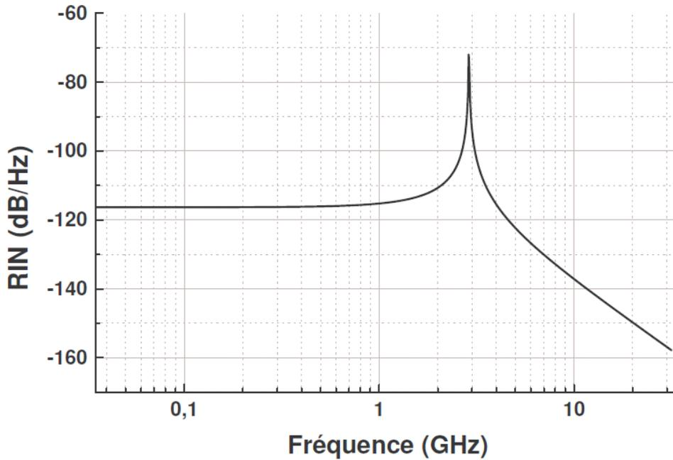
FIGURE 3.1 – Simulation du RIN d'un laser à semi-conducteur.
