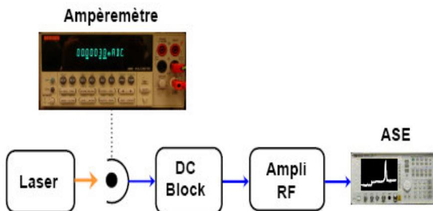
FIGURE 4.1 – Banc de mesure du bruit d'amplitude
