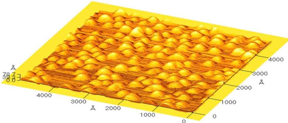
FIGURE 1.10 – Photo AFM réalisée à l’INSA. Plan d’îlots quantiques [8]
