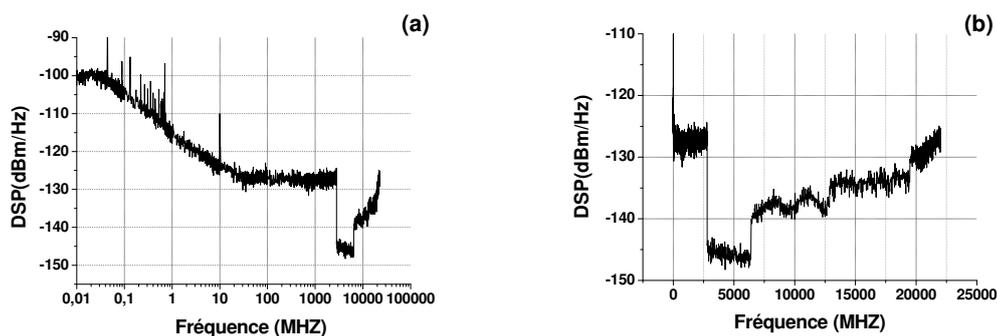
FIGURE 4.2 – Bruit thermique d'un système de détection
