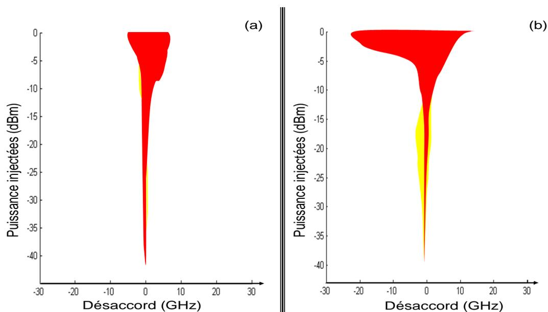
FIGURE 8.14 – Cartographies de l’injection d’un laser à batonnets quantiques à 3 plans (a) et 9 plans (b) polarisés à quatre fois leur seuil
