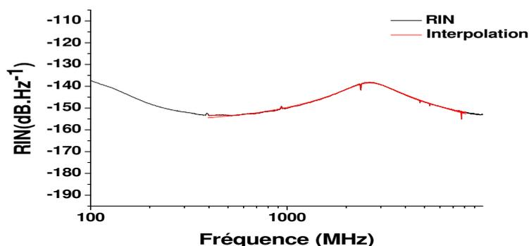
FIGURE 4.10 – Exemple d'interpolation d'une mesure de RIN
