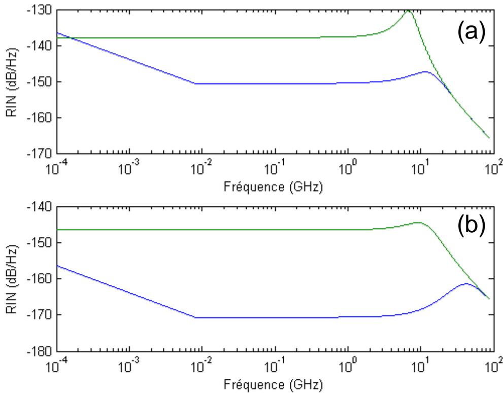
FIGURE 3.4 – Simulation numérique du RIN d'un laser à îlots quantiques. En vert  $\gamma$  et  $H$  sont négligés ( $\gamma=0, H=0$ ). En bleu ces deux termes sont pris en compte. On alors en (a),  $\rho_0 = 0.6$  soit  $\Gamma_r = 11\text{ns}^{-1}$  et  $\gamma = 8.79 \cdot 10^{21}$ . En (b),  $\rho_0 = 0.9$  soit  $\Gamma_r = 41\text{ns}^{-1}$  et  $\gamma = 9 \cdot 10^{22}\text{s}^{-2}$
