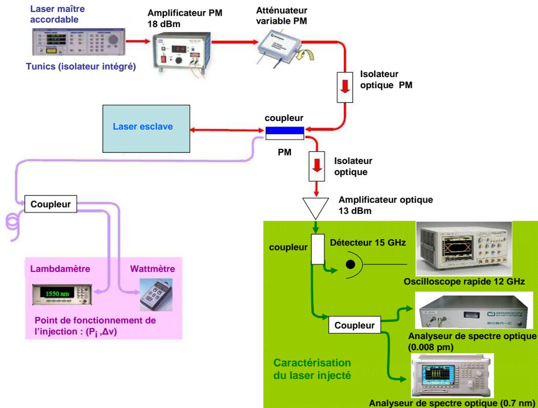
FIGURE 8.1 – Montage expérimental pour les cartographies de l'injection optique.
