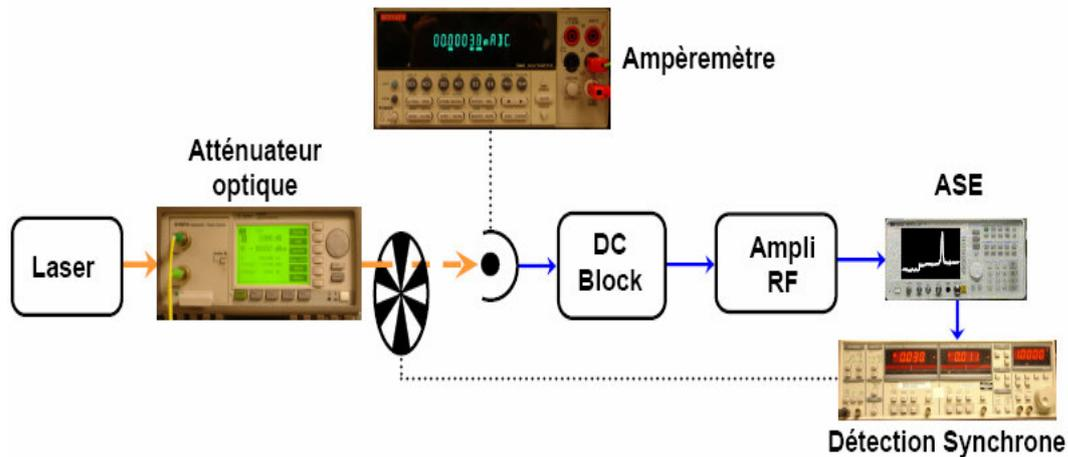
FIGURE 4.6 – Principe de la mesure précise du RIN
