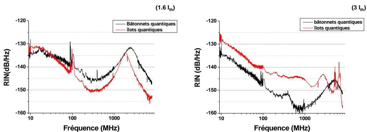
FIGURE 6.14 – Comparaison du bruit dans un laser à îlots quantiques et à bâtonnets quantiques.
