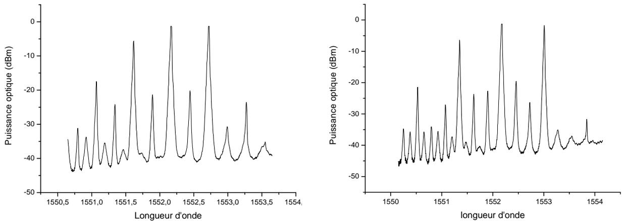
FIGURE A.8 – Spectre optique de l’extinction d’un mode sur deux et de deux modes sur trois
