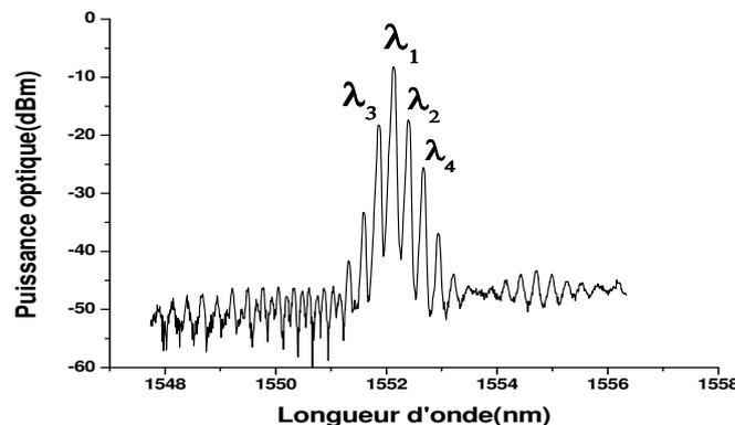
FIGURE 5.6 – Spectre optique du laser dBR.
