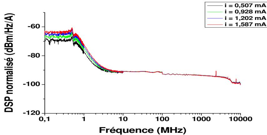
FIGURE 4.5 – DSP normalisé par rapport au photocourant
