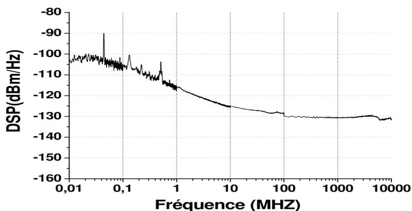
FIGURE 4.3 – Bruit thermique du système de détection 10KHz-10GHz
