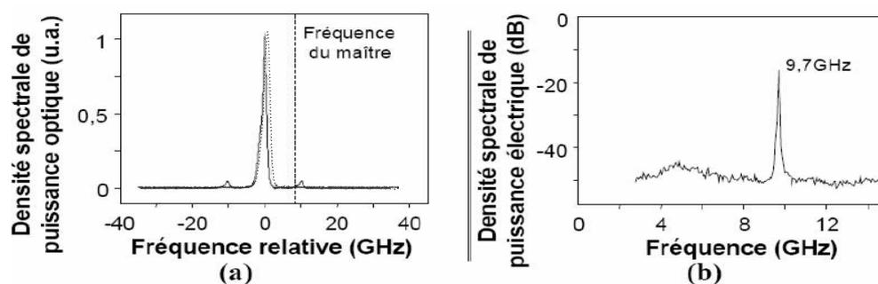
FIGURE 7.3 – Spectres caractéristiques du mélange d'ondes simple.
