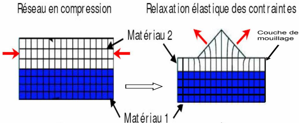
FIGURE 1.8 – Principe de croissance des boîtes quantiques
