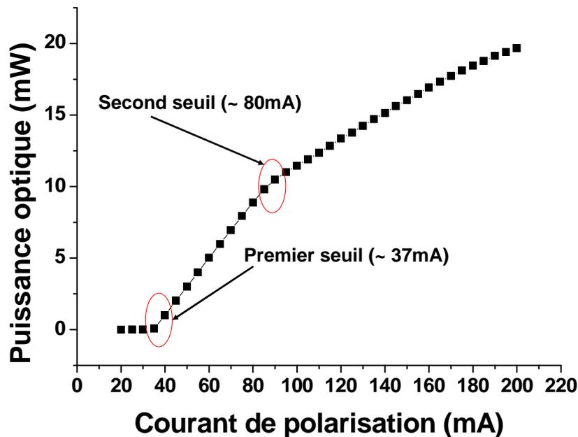
FIGURE 6.12 – Puissance optique en fonction du courant dans un laser à îlots quantiques
