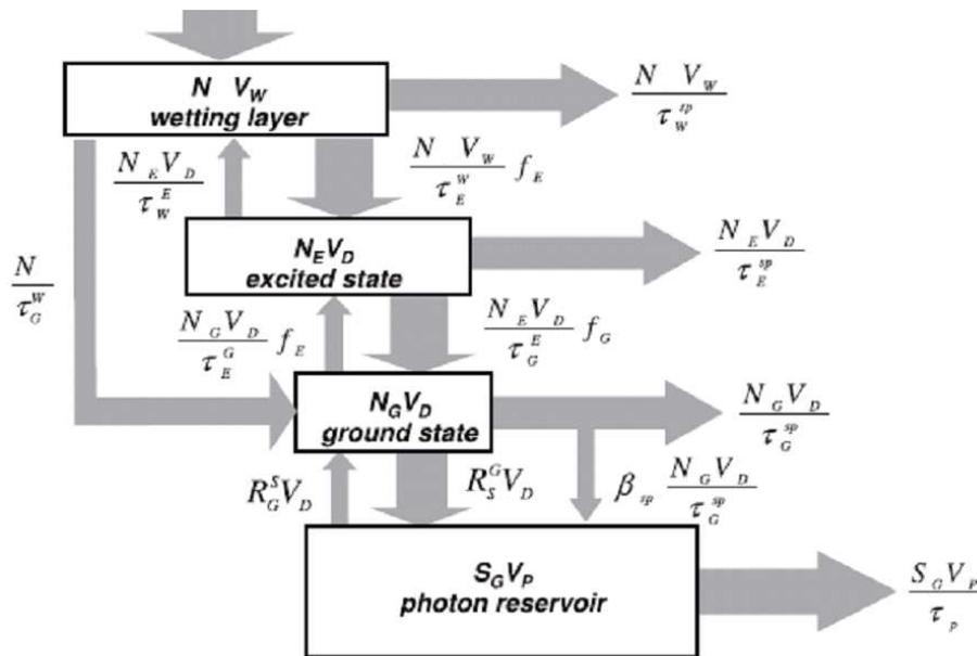
FIGURE 3.3 – Représentation schématique des transitions décrites par le modèle de Veselinov [44]
