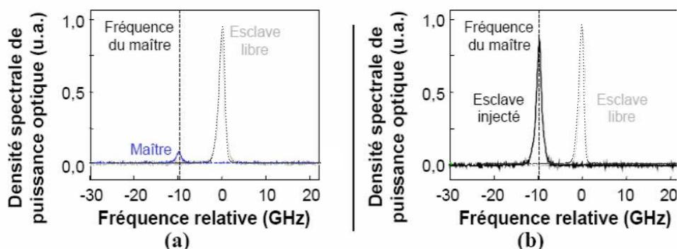
FIGURE 7.2 – Spectres caractéristiques de l'accrochage en fréquence.
