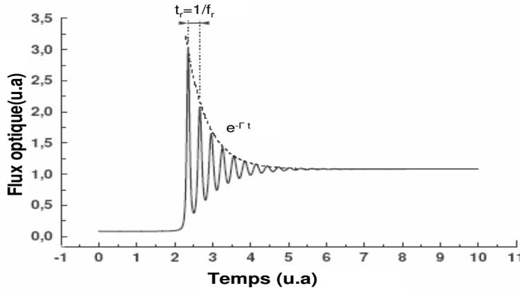
FIGURE 4.11 – Simulation numérique de la réponse d'un laser à un échelon de pompe
