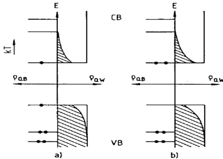
FIGURE 1.3 – Densité d'états de la bande de conduction (CB) et de la bande de valence (VB) pour le système 2D idéal ( $\rho_{QW}$ ), et le système 0D idéal ( $\rho_{QB}$ , et densité d'états occupés (zones hachurées et point noirs (électrons)) au seuil de transparence a), et au-delà du seuil b)(d'après Gérard [10])
