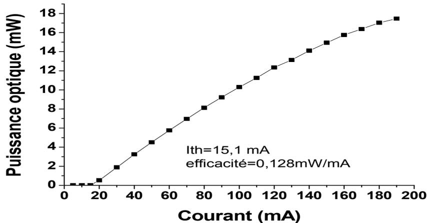
FIGURE 2.3 – Caractéristiques puissances optique en fonction du courant
