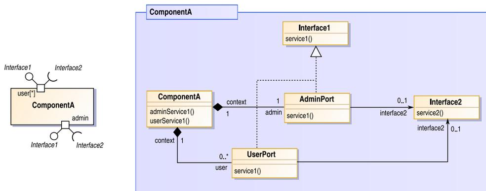
FIG. 5.3 – Un patron pour supporter les ports multiples et complexes dans Fractal
