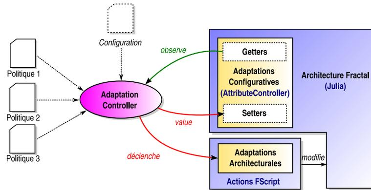
FIG. 5.1 – Principe général du contrôleur d'adaptation pour Fractal
