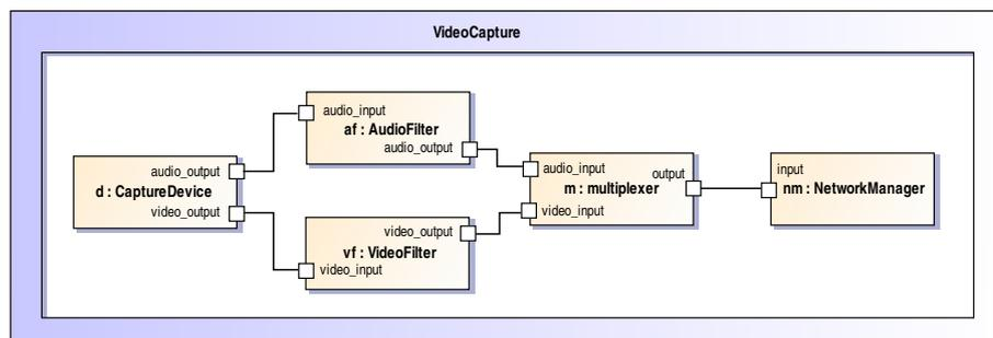
FIG. 2.1 – Une architecture possible pour un système de capture vidéo
