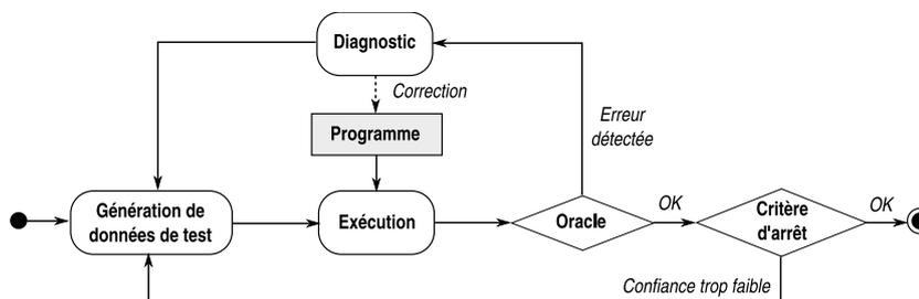
FIG. 2.2 – Principe général du processus de vérification dynamique
