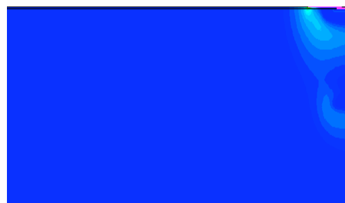
Figure 45: Répartition du champ électrique dans le FLYMOS™ sans structure de garde.
