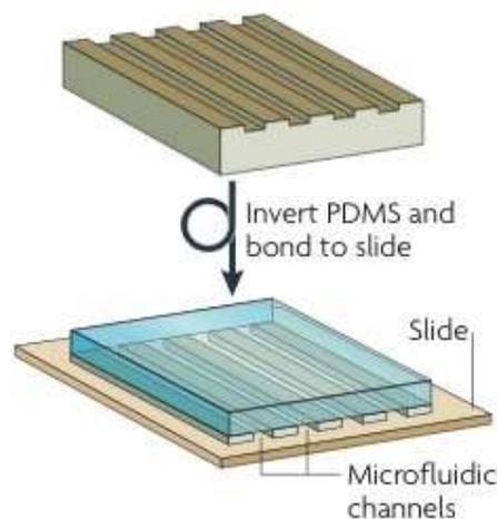
**FIG. III.17:** Principe de fabrication de microcanaux. Le moule est fabriqué de manière similaire à la description de la figure III.15, puis les canaux sont collés sur une surface en verre par simple contact après passage au plasma (repris de [Weibel *et al.*, 2007]).
