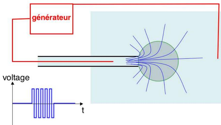
**FIG. III.10:** Principe de l'électroporation : une des électrodes baigne dans le milieu d'observation et l'autre est insérée à l'intérieur de la micropipette ; le générateur permet de délivrer des séries de pulses d'amplitude / forme / durée contrôlées. Sur le schéma on a représenté en bleu l'allure supposée des lignes de champ, avec un effet dont l'intensité est maximale à proximité immédiate de l'embout de la micropipette.
