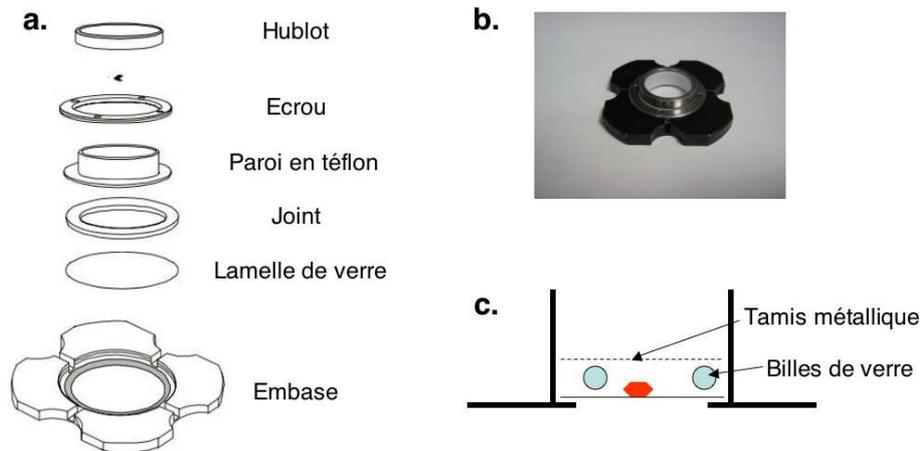
**FIG. II.1:** a) Schéma de la chambre d'observation utilisée pour les observations en microscopie. b) Photo de la chambre. c) Schéma du dispositif avec grille métallique et billes de soutien permettant de définir un compartiment protégé lors des changements de bain.
