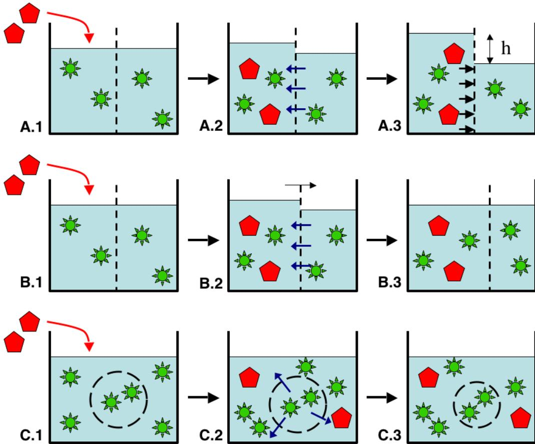
FIG. III.2: Réaction à une perturbation osmotique, 3 cas d'école : A). 2 compartiments séparés par une membrane fixe ; B). 2 compartiments séparés par une membrane mobile ; C). une vésicule dans un réservoir. Inspiré de [Freifelder, 1985]
