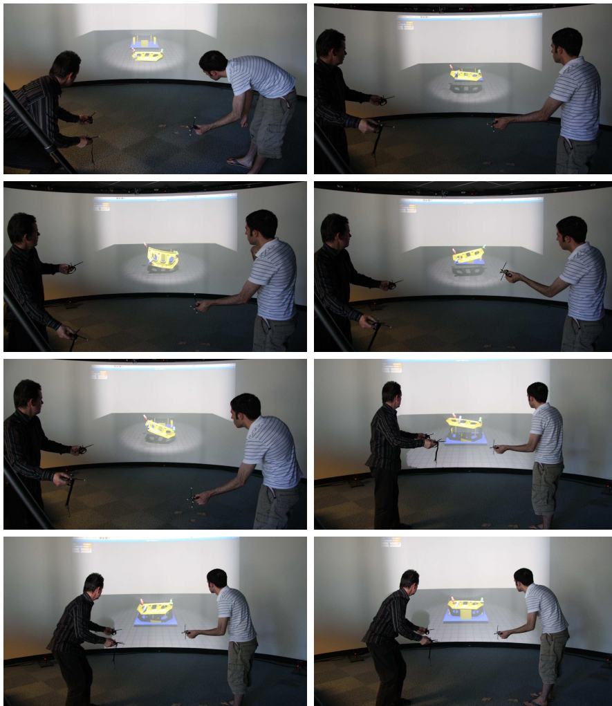
FIG. 4.5 – Séquence de manipulation à deux utilisateurs par la technique à trois mains. On observe notamment que l'utilisateur qui utilise ses deux mains peut faire varier l'assiette du capot autour de l'axe qui le relie à l'autre utilisateur. Par ailleurs, chaque utilisateur peut faire varier l'assiette autour de l'axe qui sépare les deux utilisateurs : l'utilisateur à une main monte ou descend sa main tandis que l'utilisateur à deux mains doit les monter ou les descendre simultanément.
