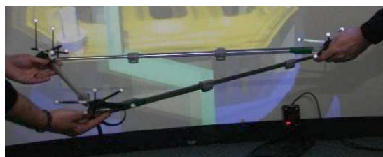
FIG. 5.4 – Illustration de l'interface tangible reconfigurable triangulaire. L'utilisateur à gauche tient le RTD-3 par ses deux mains, aux coins, tandis que l'autre utilisateur n'en emploie qu'une seule.
