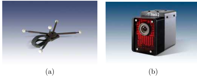
FIG. 4.2 – (a) Exemple d’une cible dont les positions des balles réfléchissantes sont capturées par des caméras infrarouges. Cette cible était tenue à bout de doigts par un utilisateur de la technique à 3 mains. Elle pèse environ 30 g. Les autres cibles étaient quasiment identiques (dimensions, allure et poids) à celle-ci. (b) Exemple d’une caméra infrarouge utilisée.
