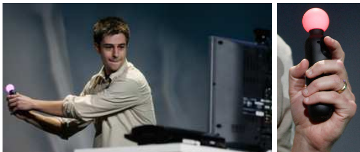
FIG. 4.4 – Capture de mouvements pour le grand public avec la manette de Sony.
