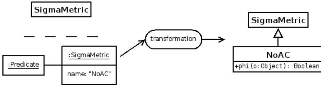
FIG. 3.19 : Principe de la transformation d'une instance en sous-classe du métamodèle
