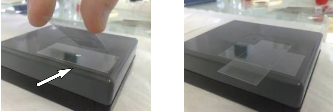
Fig II.D.10 : Une goutte du mélange réactionnel est disposée au milieu d'une première lamelle. Avec la seconde lamelle que nous laissons tomber sur la première, nous écrasons la goutte.
