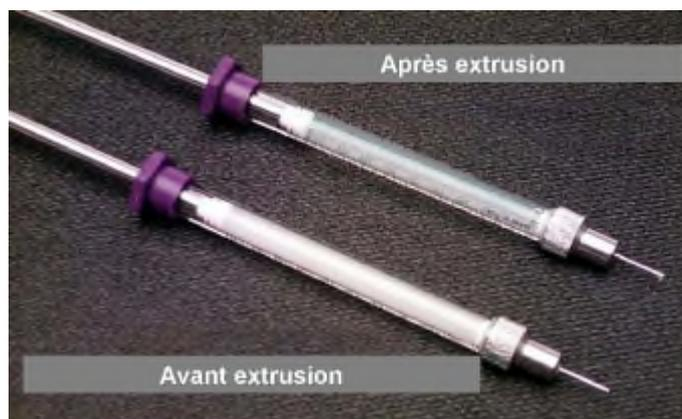
Fig II.C.16. Solution de MLV avant et après extrusion
