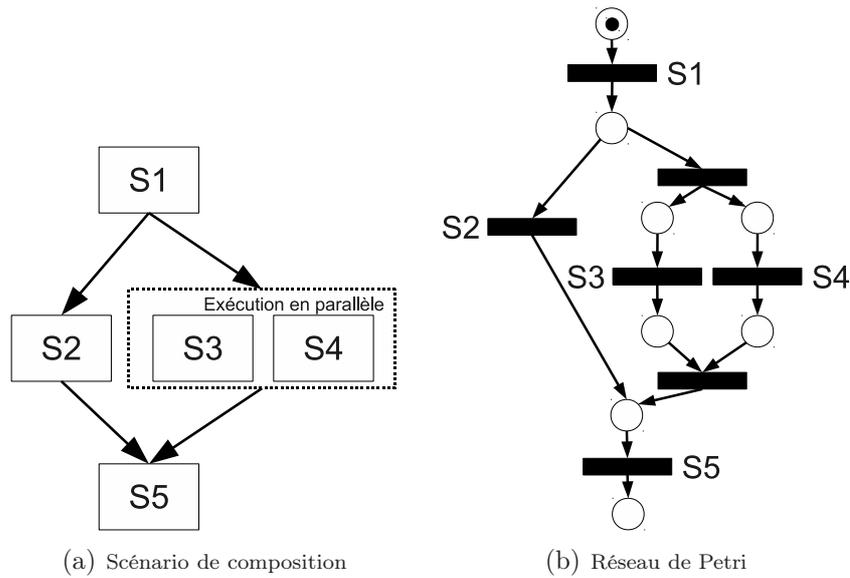
FIGURE 2.3 – Exemple de modélisation par réseau de Petri d'un service composé
