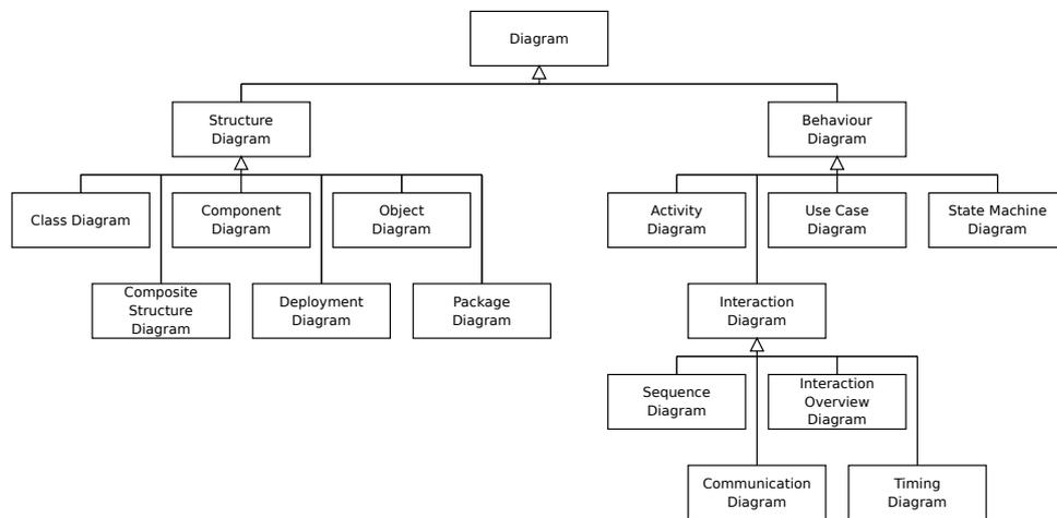
FIGURE 2.8 – Diagrammes UML 2.0
