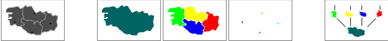
FIG. 2.3 – Représentation d'un arbre des coupes Max-Tree : (de gauche à droite) image à niveaux de gris, composantes connexes aux trois différents niveaux de gris, et arbre correspondant..
