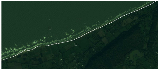
FIG. 3 – Segmentation avec 2 marqueurs (terre et mer) d'une image multispectrale pour l'extraction du trait de côte.
