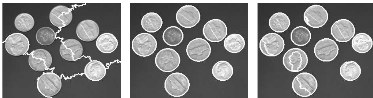
FIG. 2.14 – Formalisation de la segmentation comme une classification et influence du nombre de classes (de gauche à droite) : sous-segmentation (6 classes), segmentation correcte (11 classes) et sur-segmentation (16 classes).
