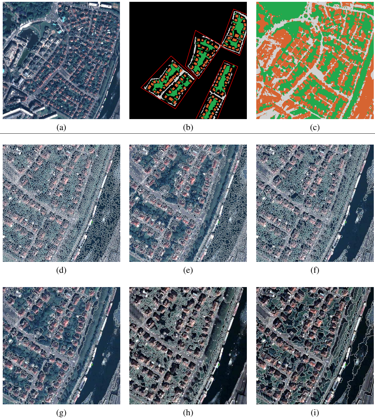
FIG. 3.11 – Intérêt d'une segmentation supervisée pour l'interprétation / classification d'images satellite à très haute résolution spatiale : (a) image initiale, (b) zones d'apprentissage, (c) classification orientée-objets produite à partir d'une segmentation supervisée. Comparaison des résultats obtenus en segmentation d'images urbaines sans marqueur, par différentes méthodes : (d) segmentation LPE classique, (e) segmentation supervisée par changement d'espace, (f) segmentation supervisée par optimisation de paramètres, (g) segmentation supervisée par changement d'espace et optimisation de paramètres, (h) utilisation du logiciel ENVI, (i) utilisation du logiciel eCognition.
