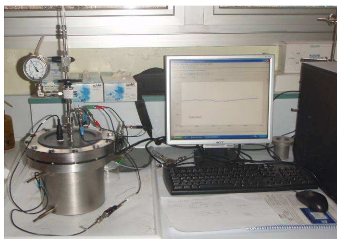
Figure II-17 : Schéma et photographie du montage équipé pour le suivi électrochimique en milieu anoxique
