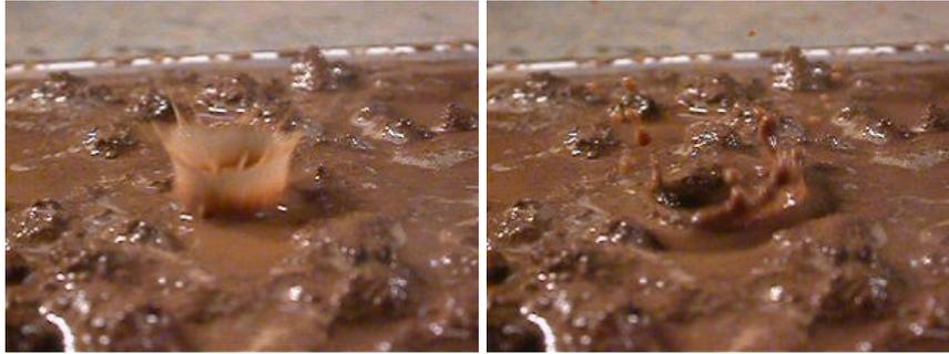
FIG. 1.3 – *Rejaillissement du sol et de l'eau suite à l'impact d'une goutte d'eau, ou effet splash.*
