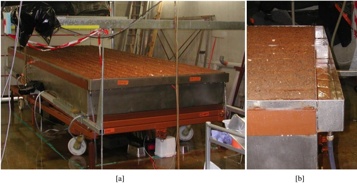
FIG. 2.4 – Structure du bac de  $5 \times 2 \text{ m}^2$ . Vue générale depuis l'aval présentant l'ensemble du bac constitué de deux parties de  $5 \times 1 \text{ m}^2$  (a). Détail du système de recueil du ruissellement (b).
