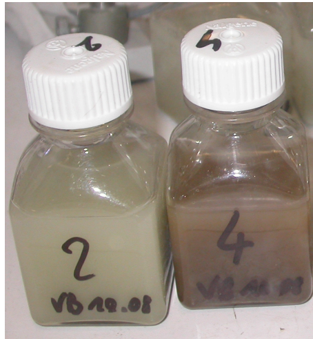
Figure 10 : Photographie de suspensions de sidérite après 60 h de réaction avec Se_t = 1 \cdot 10^{-4} \text{ mol.L}^{-1} de Se(IV) (flacon 2) et Se_t = 1 \cdot 10^{-3} \text{ mol.L}^{-1} de Se(IV) (flacon 4). La couleur de la suspension du flacon 2 est identique à celle d'une suspension de sidérite pure.
