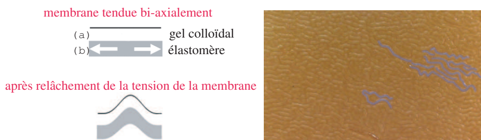
FIG. 2.11 – Une couche (a) d’une suspension de particules de nanolatex (billes déformables) est déposée sur une membrane élastomère tendue bi-axialement (b). Après consolidation de la couche de particules colloïdales, la tension de la membrane (b) est relâchée. Il se forme un réseau de plis dont certains sont surlignés en bleu. Largeur de l’image : 3cm.
