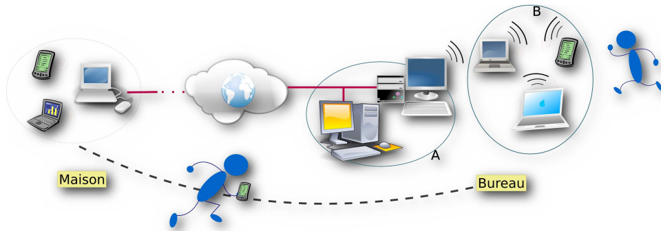
FIG. 1.2: Exemple d'un réseau dynamique. Un utilisateur a accès à un ensemble de machines comprenant des équipements mobiles et fixes.
