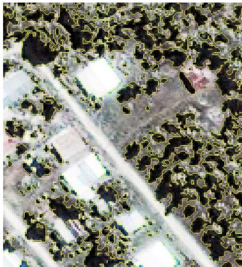
FIG. 7.2 – Résultat de la segmentation des zones d'ombres avec la méthode de Polidorio.
