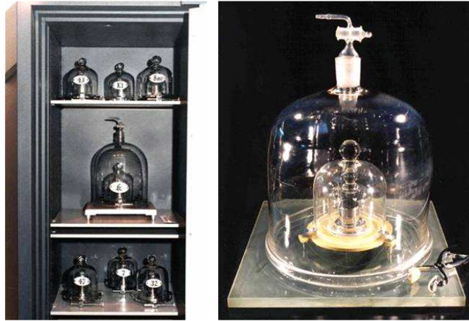
FIG. 1.4 – A gauche, prototype international du kilogramme \mathcal{K} et ses six témoins, sous cloches dans un coffre au BIPM à Sèvres. A droite, copie sous trois cloches
