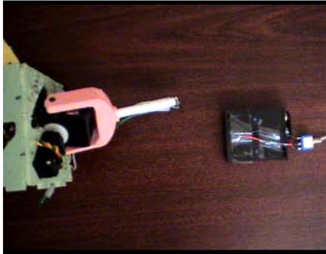
Figure 5.3 Lecture d'un signal IR par le capteur au bout de la patte
