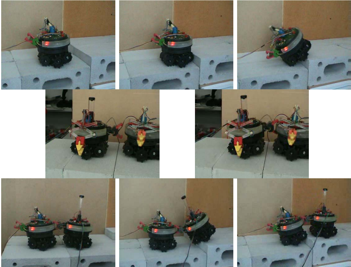
Figure 1.28 Séquence d'un s-bot avec un obstacle infranchissable, reconfiguration et franchissement de l'obstacle
