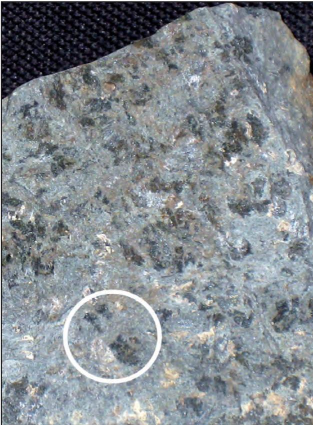
phiboles bleues et vertes au cours du métamorphisme alpin HP-BT. Les sites des plagioclases sont occultés par l'association zoïsite, + amphiboles, ± chlorite, ± grenat et chori-toïde. L'assemblage amphiboles, ± chlorite, ± talc semble s'être développé aux dépens des olivines et/ou des orthopyroxènes. Ces minéraux de haute pression sont la plupart du temps rétrotransformés en un assemblage d'albite, d'amphibole verte et de chlorite (fig. 2. 40).
