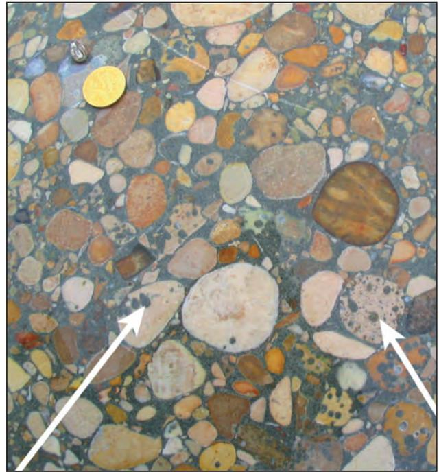
Fig. 2. 32 - Section polie d'un échantillon de conglomérat de Bourdeau (Morestel), les flèches blanches indiquent les perforations qui affectent de nombreux galets calcaires © D. Tritenne.
