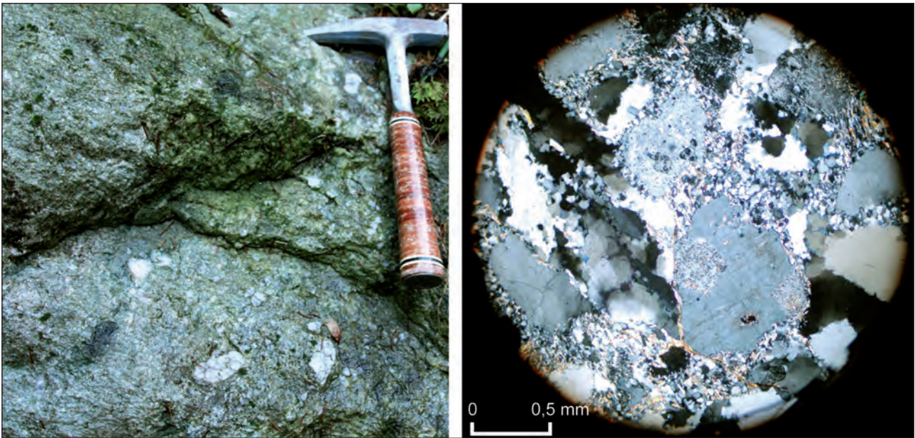
Fig. 4. 12 – A gauche, détail macroscopique de grès de base du Permo-Trias ; à droite, détail d'une lame mince : la roche est essentiellement faite de grains de quartz corrodés et partiellement recristallisés. Des reliques feldspathiques peuvent aussi s'observer, elles marquent le caractère arkosique de certains niveaux de la série du Trias inférieur.
