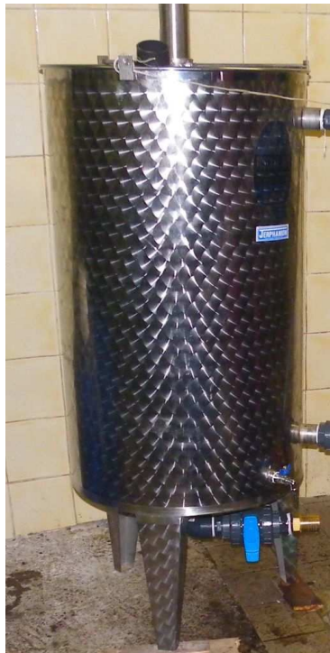
Figure 13 : Cuve de décantation en inox
