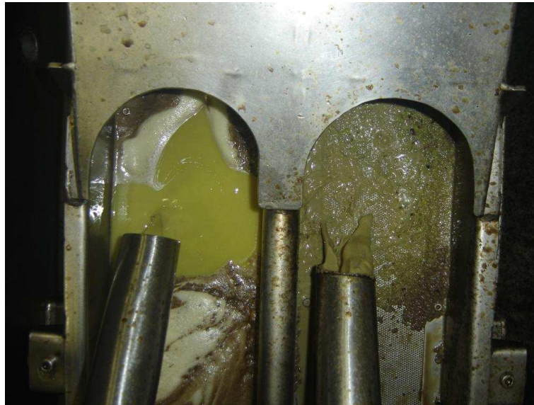
Figure 10 : Sortie d'une centrifugeuse 3 phases, à droite les grignons humides, à gauche l'émulsion huile/eau
