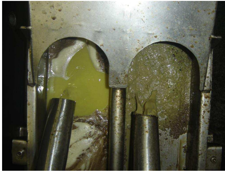
Figure 10 : Sortie d'une centrifugeuse 3 phases, à droite les grignons humides, à gauche l'émulsion huile/eau
